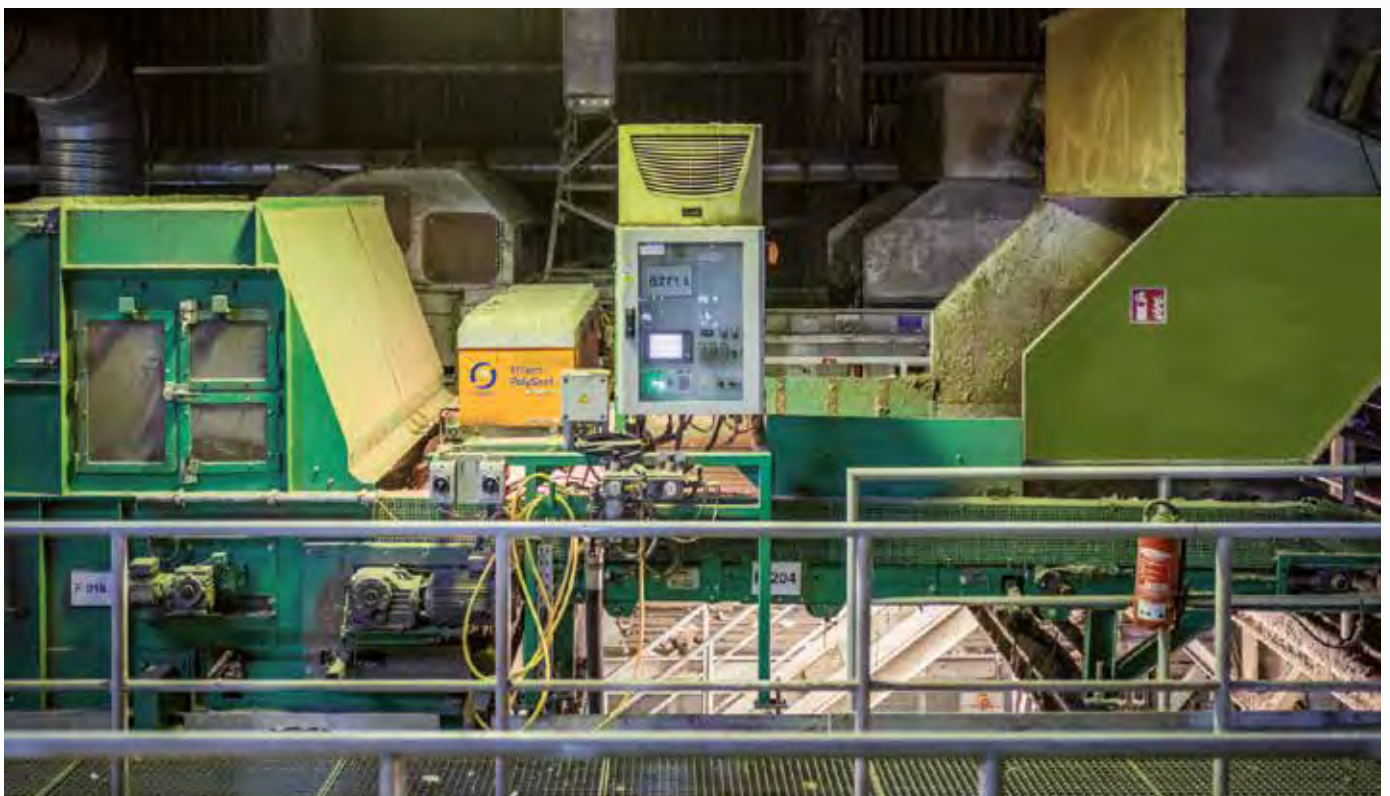
NIR (Nahinfrarotspektroskopie) mit der Detektionseinheit (orange). NIR (Near infrared spectroscopy) with the detection unit (orange).
